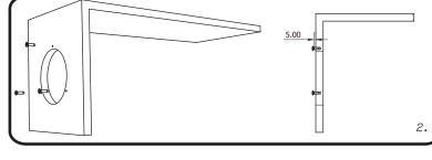
2. เจาะเคาท์เตอร์เป็นวงกลมตามแบบ และไขสกรูเกลียวปล่อยตามตำแหน่ง โดยให้หัวของสกรูห่างจากผนัง 5 มม. สำหรับใช้ยึดกับหัวของเครื่องจ่ายแก้ว
