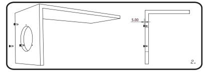
2. เจาะเคาท์เตอร์เป็นวงกลมตามแบบ และไขสกรูเกลียวปล่อยตามตำแหน่ง โดยให้หัวของสกรูห่างจากผนัง 5 มม. สำหรับใช้ยึดกับหัวของเครื่องจ่ายแก้ว
